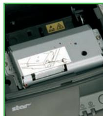
Cuchilla de guillotina resistente y de alta velocidad para lograr una mayor fiabilidad
